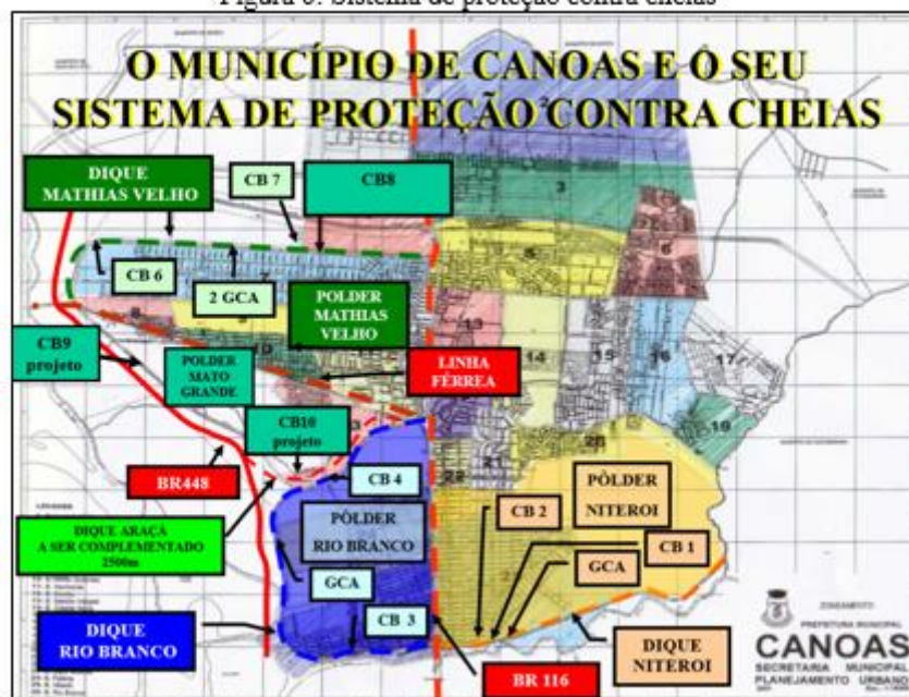
Figura 6: Sistema de proteção contra cheias
