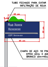
DETALHE PLACAS DE IDENTIFICAÇÃO DAS RUAS
