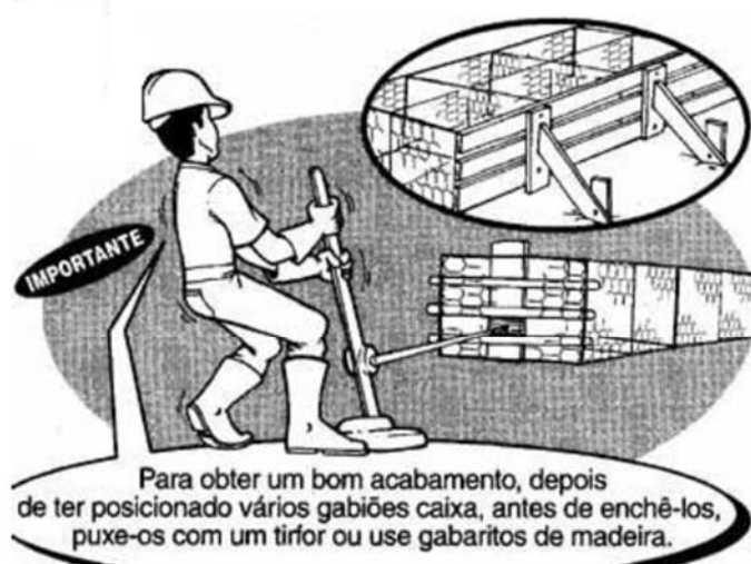
Figura 5. Detalhe da utilização do tirfor ou gabarito.
