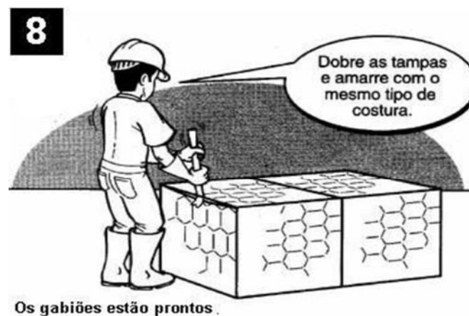
Figura 9. Detalhe da etapa de fechamento do gabião tipo caixa.
