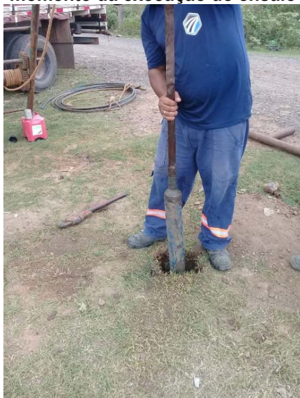
Foto 7 - Vista da Coleta Shelby C03 no momento da execução do ensaio
