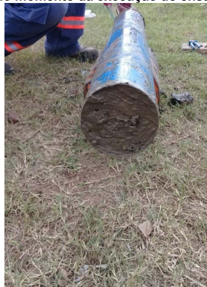
Foto 8 - Vista do amostrador Shelby furo C03 no momento da execução do ensaio
