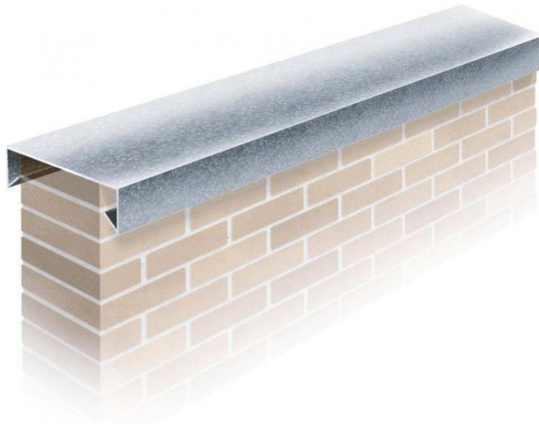
Fig. 44 – Exemplo de Topo de Alvenaria (Capa de Muro) com pingadeira – Fonte Google.
