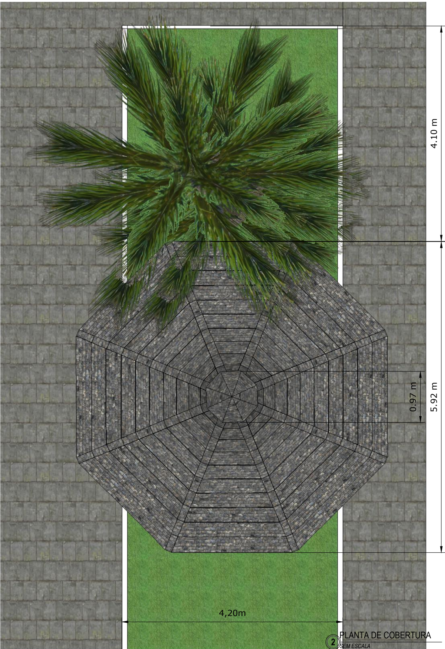
REVESTIMENTO - "TELHAS" EM PEÇAS DE BASALTO 15X15X0,01cm DETALHE 4 / PAGINA 8
