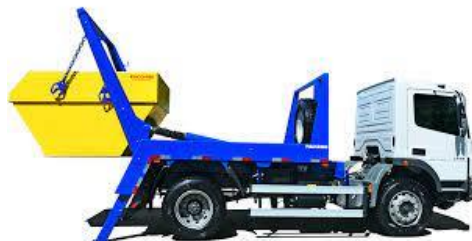
Figura 5 – Ilustração do modelo de caminhão com poli guindaste, para operação com caçambas estacionárias;
