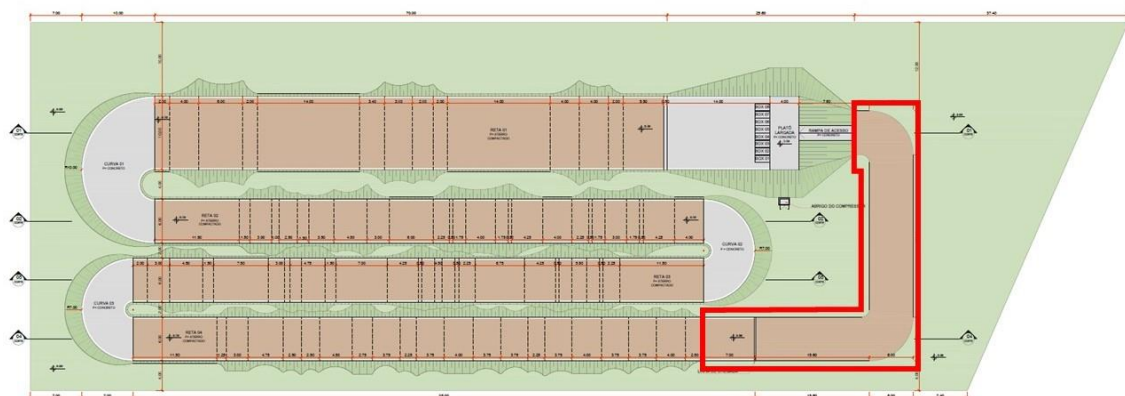
Figura 2 - Área de limpeza da camada vegetal e compactação de solo
