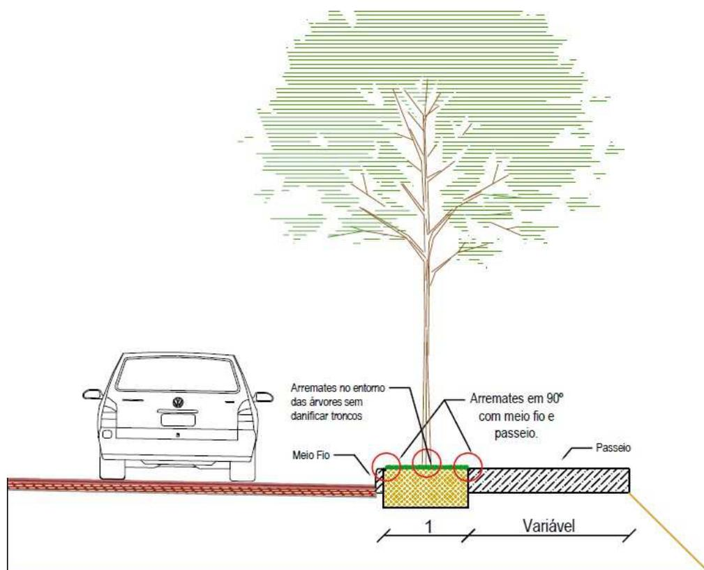
Figura 1- Detalhe dos arremates no meio fio, passeios e entorno das árvores
