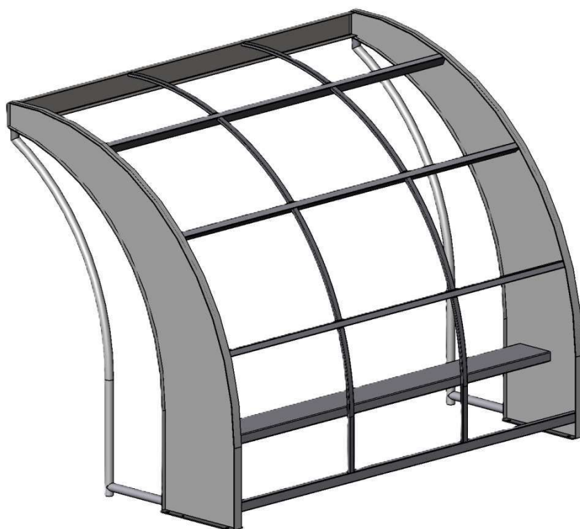
Figura 4 - Estrutura Metálica – Perspectiva
