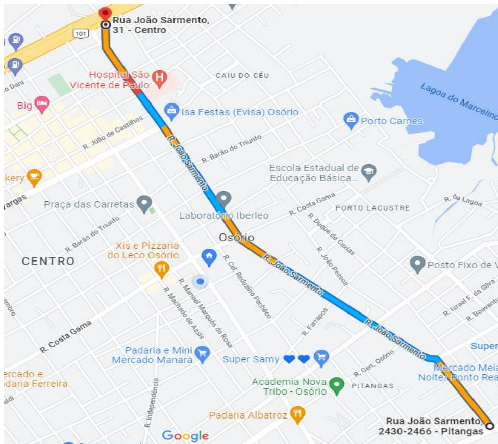
Revitalização da sinalização horizontal existente na Rua Santos Dumont, com extensão total de 3,9km. Sendo 2km de eixo de pista tracejado em amarelo, 300m de eixo de pista continuo em amarelo e 1,6km de eixo de pista tracejado em branco (pista dupla de 800m).
