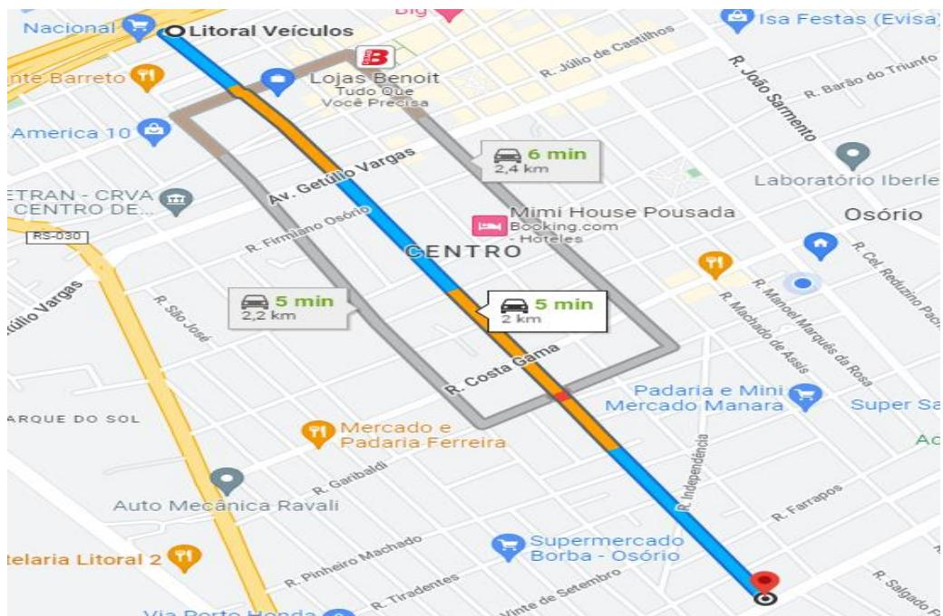
O levantamento tem aproximadamente a extensão total de 29,6km de vias urbanas a serem revitalizadas, além disso é necessário uma estimativa de 2km de eixo de pista continuo na cor amarelo e 2km de eixo de pista continuo na cor branca, tendo em vista os cruzamentos serem demarcados com 15 metros para cada lado.
