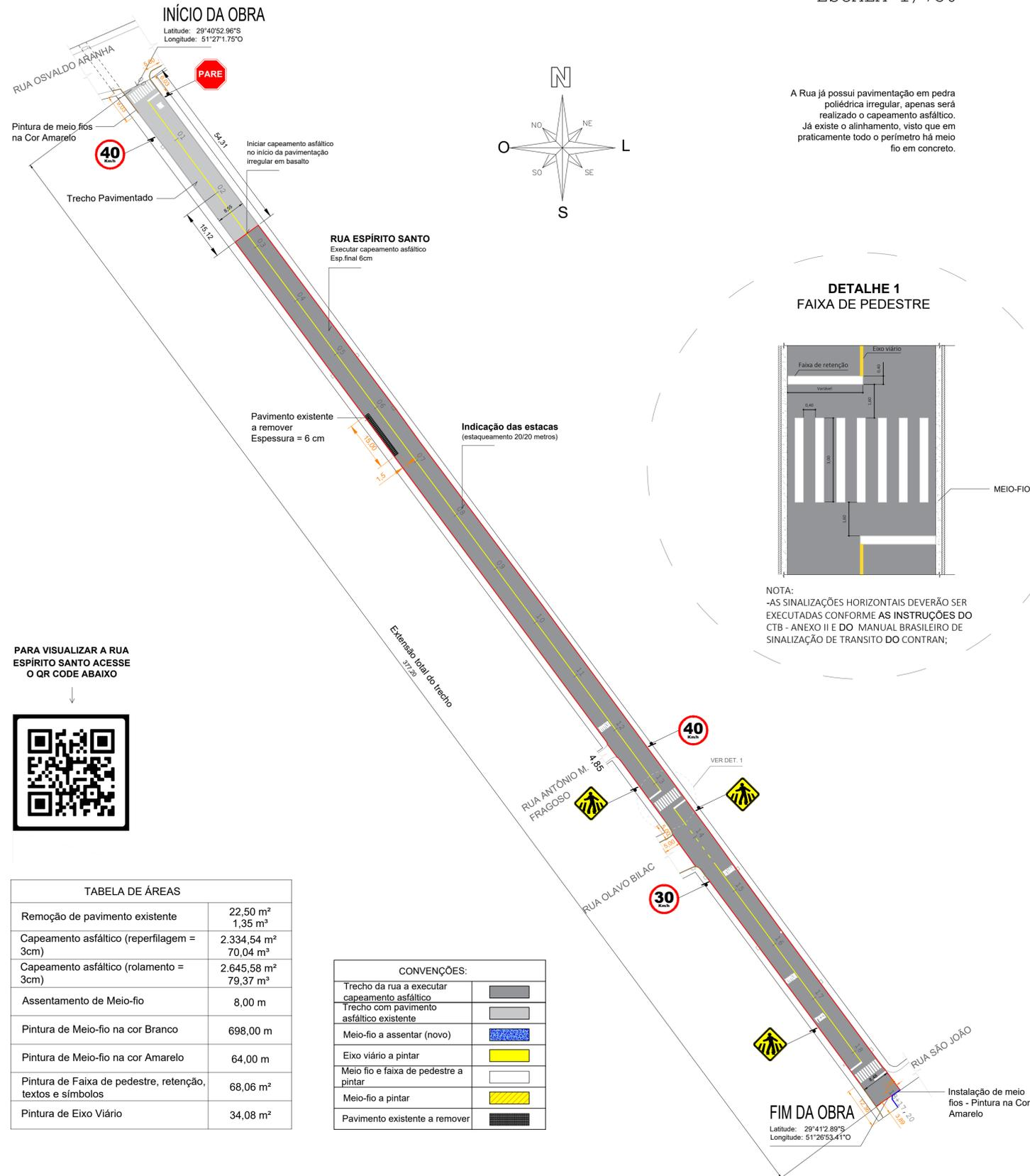
A Rua já possui pavimentação em pedra poliédrica irregular, apenas será realizado o capeamento asfáltico. Já existe o alinhamento, visto que em praticamente todo o perímetro há meio fio em concreto.
