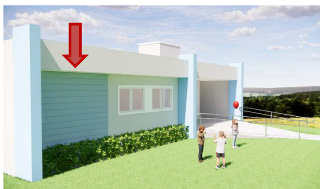
Imagem 20: Fachada frontal principal com detalhe em régua de madeira
