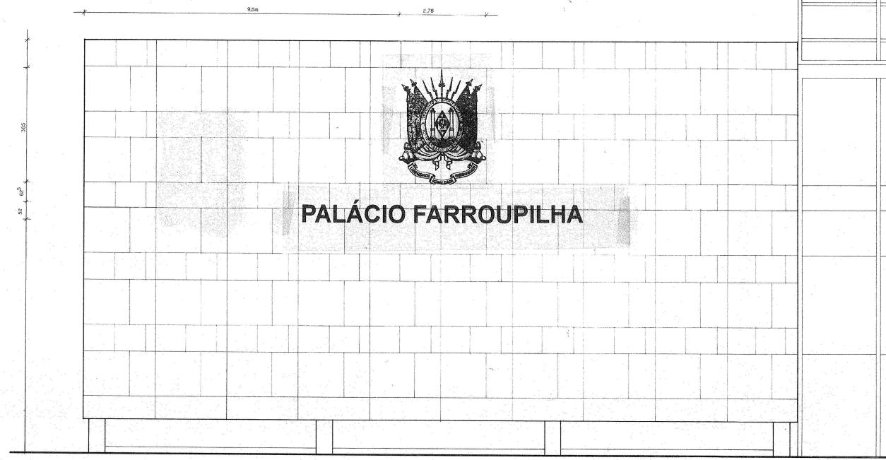
BRASÃO EM ALUMÍNIO FUNDIDO FIXADO COM PINOS NA PAREDE. ACABAMENTO COM 4 DEMAS DE PINTURA TIPO OXÍDICO, CONFORME CONSTANTES DO MODELO OFICIAL; CAMADA DE PROTEÇÃO COM DUAS DEMAS DE LACA ACRÍLICA;
