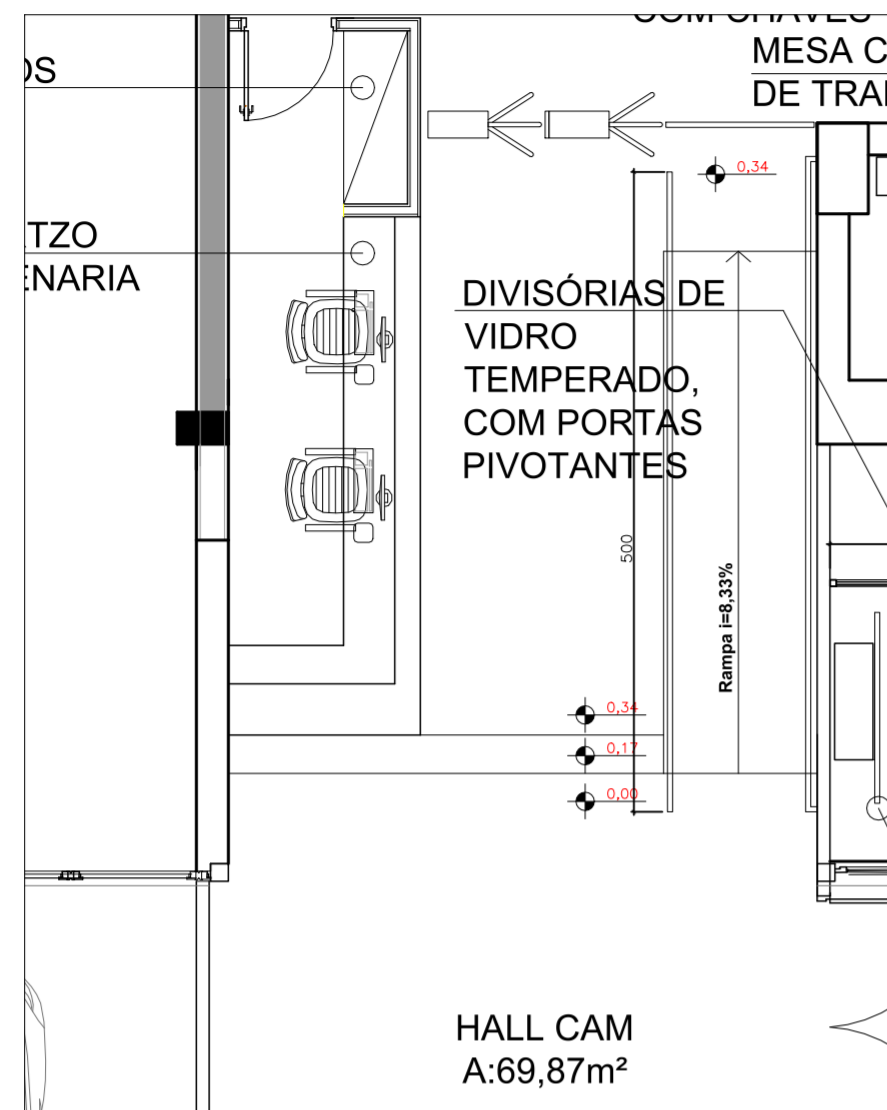
PLANTA BAIXA – CORRIMÃOS E GUARDA-CORPOS ESC.1/50
