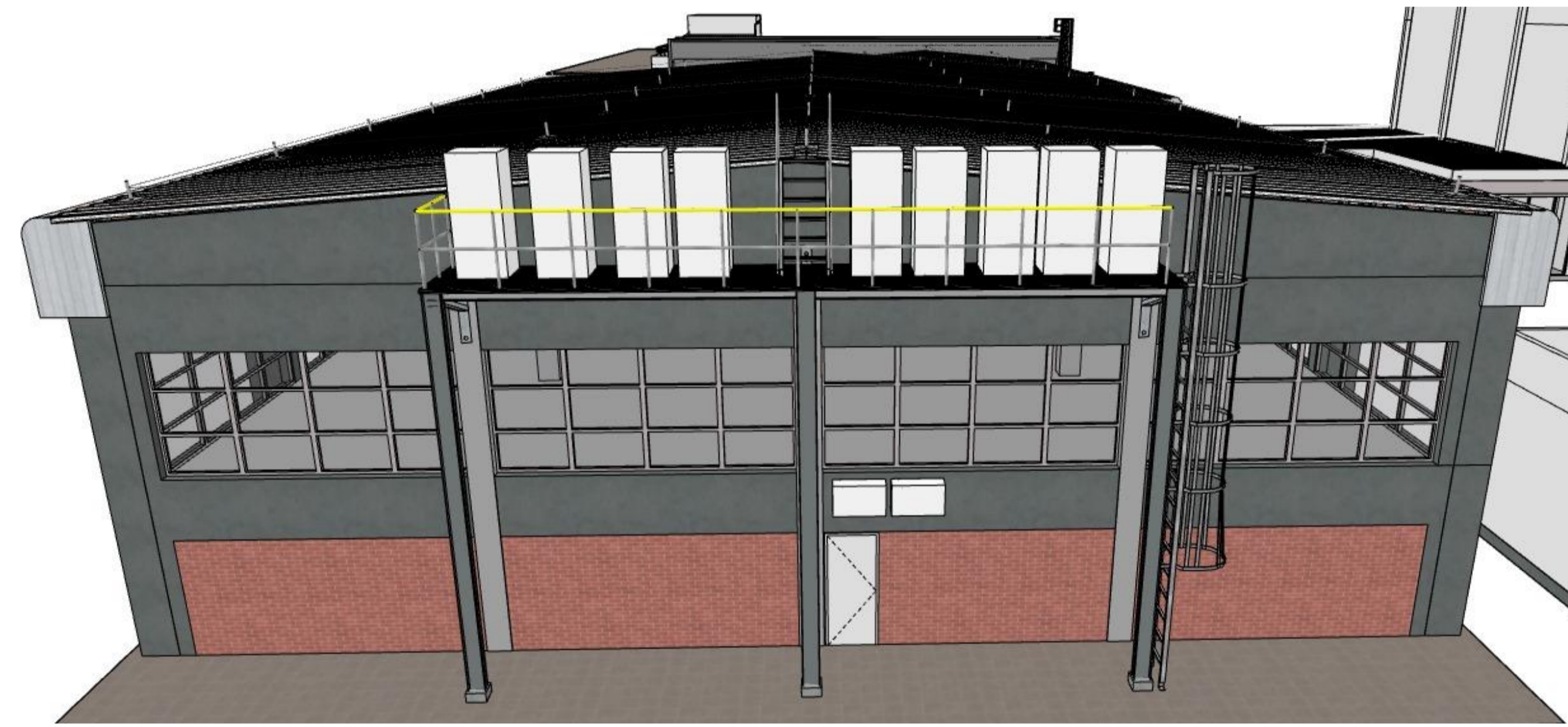
3 CORTE PLATAFORMA CONDENSADORAS 1:136,82
