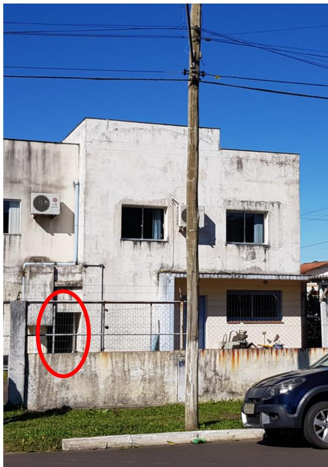
**Figura 3: Indicação do corredor entre os prédios por onde deverá passar a rede subterrânea dos cabos do disjuntor de BT até o QGBT.**
