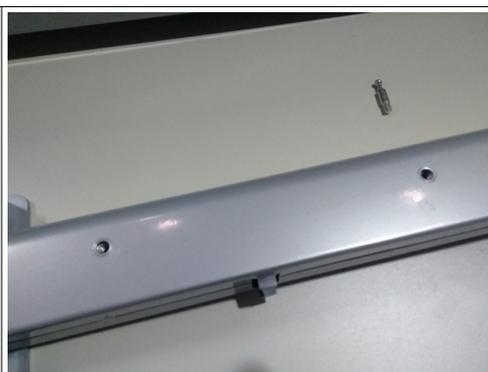
**Fig. 03: Amostra fornecida – fixação com bucha metálica**
