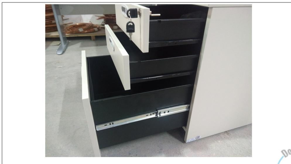
Fig. 01: Amostra fornecida -Corrediça telescópica na 3ª gaveta e ausência na 1ª e 2ª
